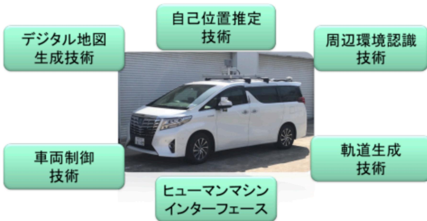
自動運転のための必要技術には、デジタル地図生成、自己位置推定、周辺環境認識、走行軌道生成・車両制御、ヒューマンマシンインターフェースなどが挙げられ、これらを統合して自動運転システムを形成しています。私たちの研究室では、これらの要素技術を幅広く研究し、自律型自動運転自動車のシステム開発を行っています。
